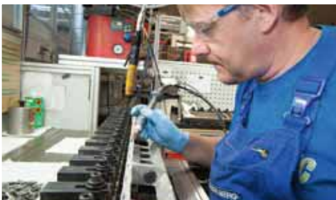
Стальные и алюминиевые детали фиксируются LOCTITE 306 на штанге устройства захвата.
