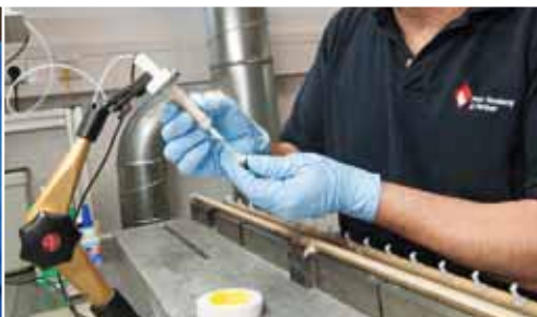
LOCTITE 406 наносится с помощью перистальтического насоса для склеивания полиамида и латуни в напорной трубке.
