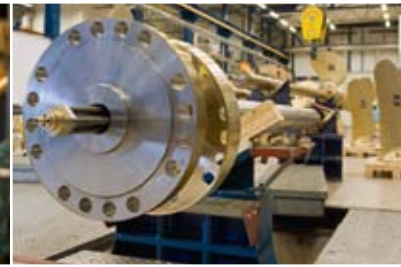
Элементы гидравлической системы находятся внутри вала
