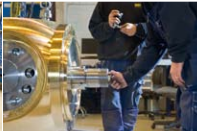
Loctite® 243 - фиксация заглушки вала на узле ступицы винта
