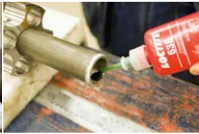
Loctite® 638 - фиксация и герметизация резьбы с помощью одного продукта
