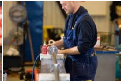
Loctite® 243 - фиксация трубок при сборке гидравлической системы
