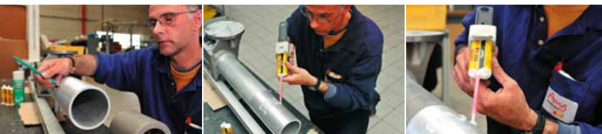
Двухкомпонентный эпоксидный состав Loctite® 9466 обеспечивает надежное склеивание литых алюминиевых деталей с тонкостенными выдерживающее нагрузку до 6G.
