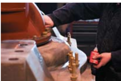
22 болта, крепящие дифференциал к заднему мосту, фиксируются с помощью Loctite® 648
