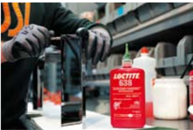
Монтаж водопроводных кранов для умывальников с помощью Loctite® 638
