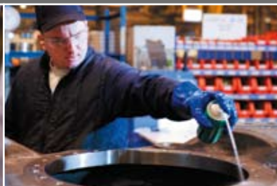
Очистка фланца дифференциала заднего моста с помощью Loctite® 7063
