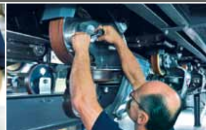
Крепление колес к поезду, болты фиксируются с помощью Loctite® 243
