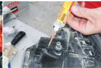
Ремонт сломанного крепления фары с помощью Loctite® 3090
