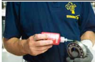
Фиксация корпусов подшипников с помощью Loctite® 638
