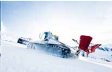
Боковые крылья обеспечивают формирование качественной лыжной трассы
