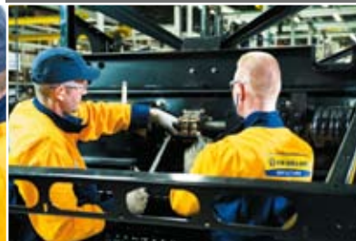
Болты главной шестерни туго затягиваются для обеспечения максимальной надежности
