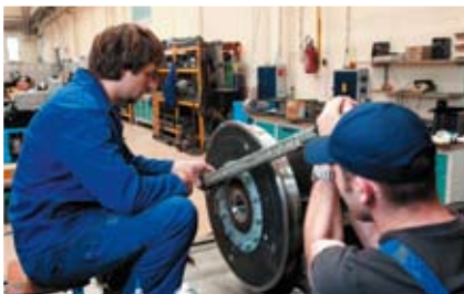
12 болтов, устанавливаемых по радиусу колеса, затягиваются, надежно удерживая колесо
