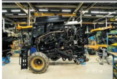
Колесный узел собран — можно приступать к следующему этапу производства комбайна
