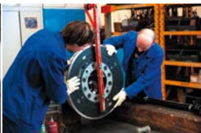
Сборка подвески колес
