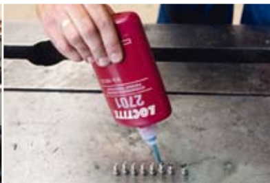
Восемь болтов из нержавеющей стали фиксируются с помощью Loctite® 2701
