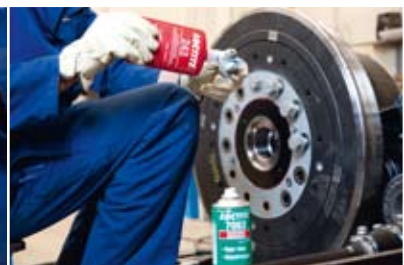
12 болтов фиксируются составом Loctite® 243
