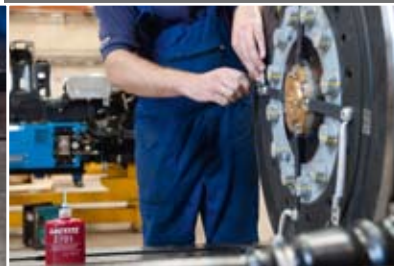
Фиксация болтов провода заземления
