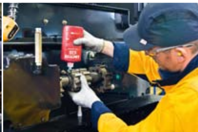
Для фиксации ступицы на валу используется высокопрочный состав Loctite® 638
