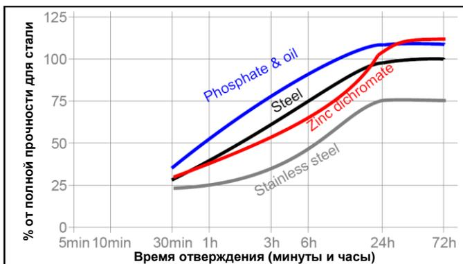
[Сверху вниз – фосфатированная и замасленная поверхность, сталь, дихромат цинка, нержавеющая сталь]
