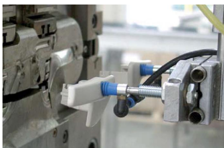
Сильфонные присоски FSG для перемещения горячих пластиковых деталей
