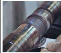
Универсальный двухкомпонентный эпоксидный состав со стальным наполнителем, устойчивый к образованию наплывов. Поверхность полимеризованного состава похожа на металлическую. Используется для восстановления изношенных металлических деталей. Типичные области применения: заделка трещин в резервуарах, отливках, в корпусах кораблей, в клапанах; устранение последствий кавитации и/или коррозии.
