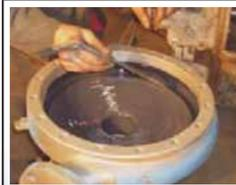
Эпоксидный состав с керамическим наполнителем, образующий гладкую блестящую поверхность. Она значительно уменьшает трение и защищает деталь от абразивного и кавитационного износа. Герметизирует зазоры и защищает оборудование от коррозионного износа. Обычно используется для обработки поверхностей ёмкостей и желобов, рулей и рулевых петель, для восстановления изношенных кавитацией деталей насосов, для ремонта гребных винтов.
