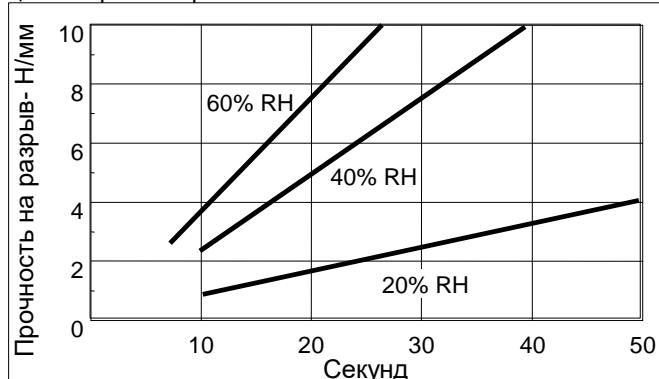
Для ускорения полимеризации при больших зазорах или низкой относительной влажности воздуха применяется активатор поверхности. Следует принять во внимание, что применение активатора может привести к снижению окончательной прочности соединения, вследствие чего рекомендуется проводить предварительные испытания.
